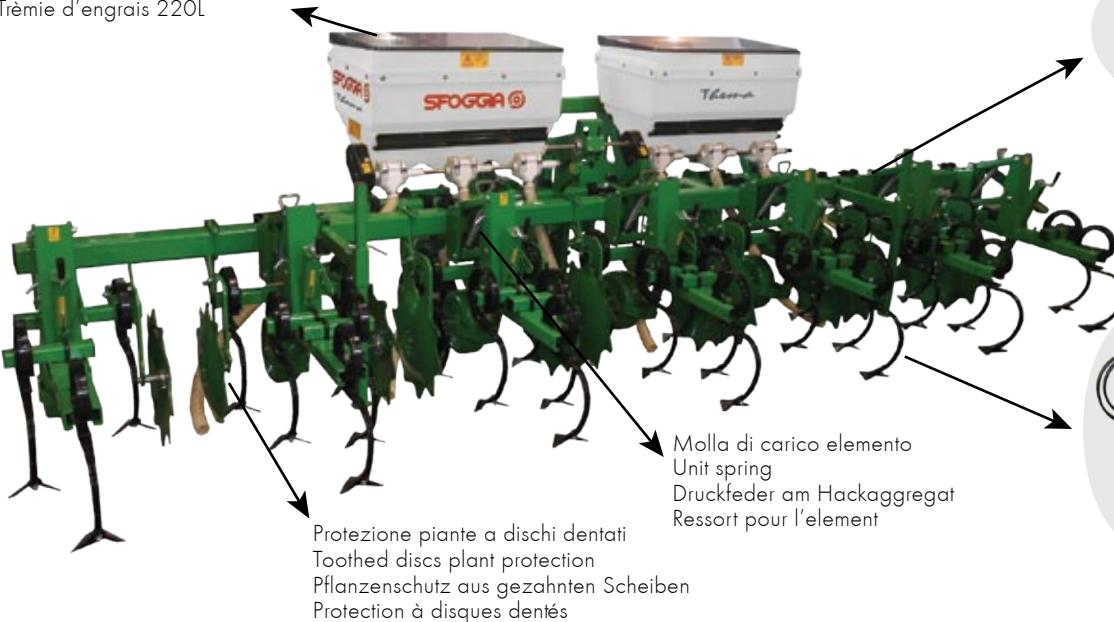
Telaio ripieghevole manuale - idraulico
