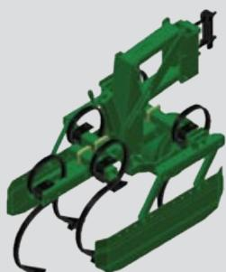
Elemento Thema versione Mais-Girasole a 5 molle flex con zappe da 150mm, o BietolaSoia a tre molle flex con zappe da 105mm e con protezione piante a bandelle.
