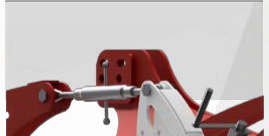
Befestigungs bolzen mit Bronze buchse mit Schmiernippel
